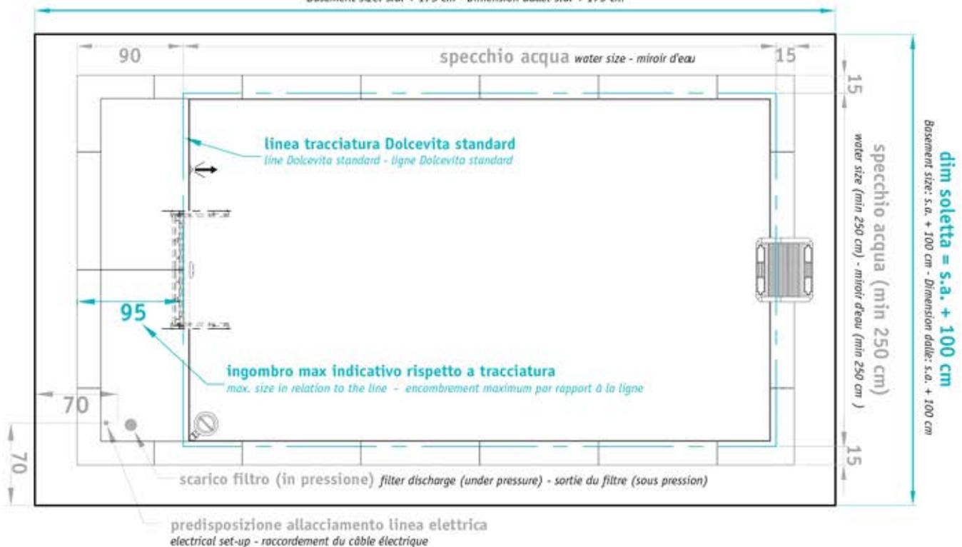
**CARATTERISTICHE OPERE CIVILI** CONCRETE BASE - CARACTERISTIQUES DU GROS OEUVRE
